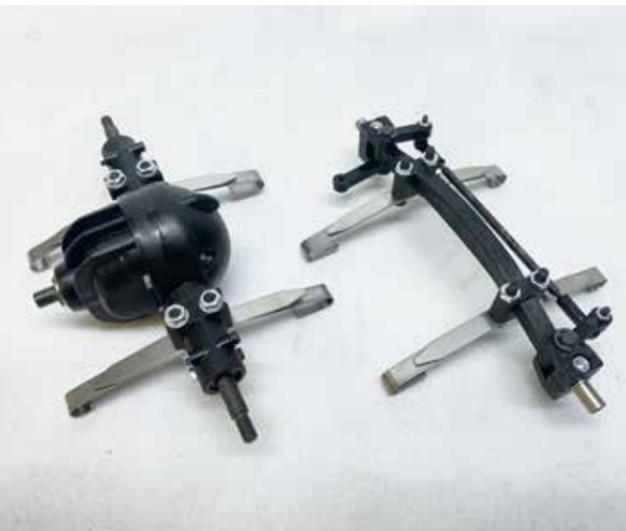
Beide Achsen werden an zweilagigen Blattfedern montiert
