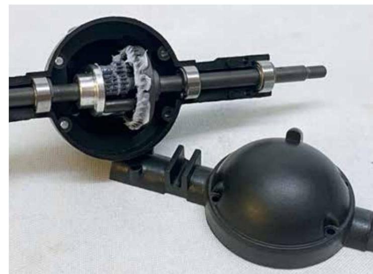
An Schmiermittel für die Zahnräder muss nicht gespart werden. Ein fast unsichtbares Detail: Das Achsgehäuse entspricht weitestgehend dem Original
