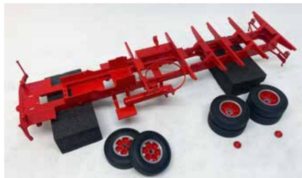
Das Fahrzeugchassis und die Felgen sind nun lackiert. Jetzt kann der Aufbau des restlichen Fahrzeuges beginnen
