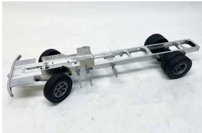
Der einteilige Fahrzeugrahmen wird mit Anbauteilen aus Kunststoff bestückt. Erste Anprobe der Trilex-Räder
