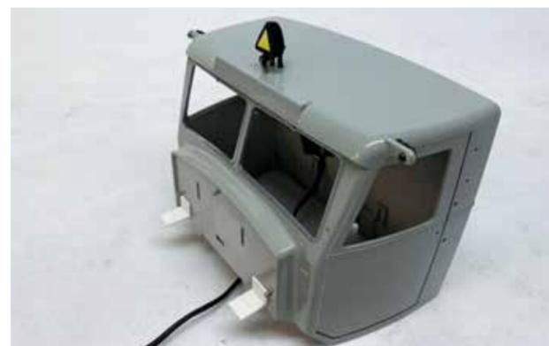
Das Fahrerhaus ist lackiert und die Beleuchtungseinrichtungen installiert. Über die beiden vorderen Winkel wird die Hütte später an den Kotflügeln befestigt
