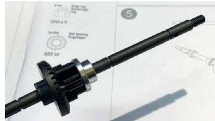
Die Antriebsachse ist mit einem Planetendifferential ausgestattet
